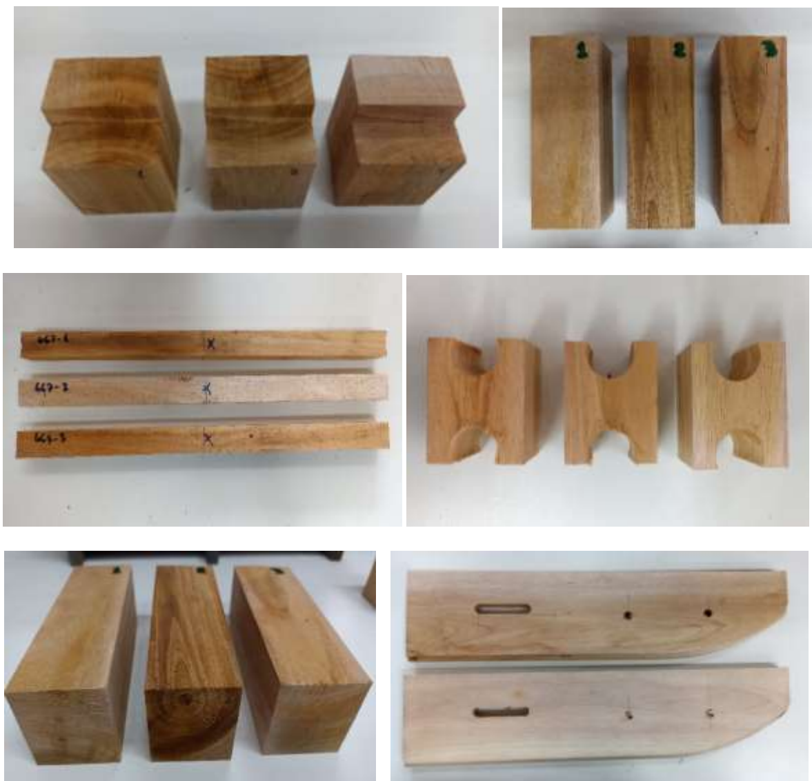
Figura 2. Probetas habilitadas para los ensayos de propiedades físicas, mecánicas y trabajabilidad -- protocolos N° 667-I al 667-LVII
